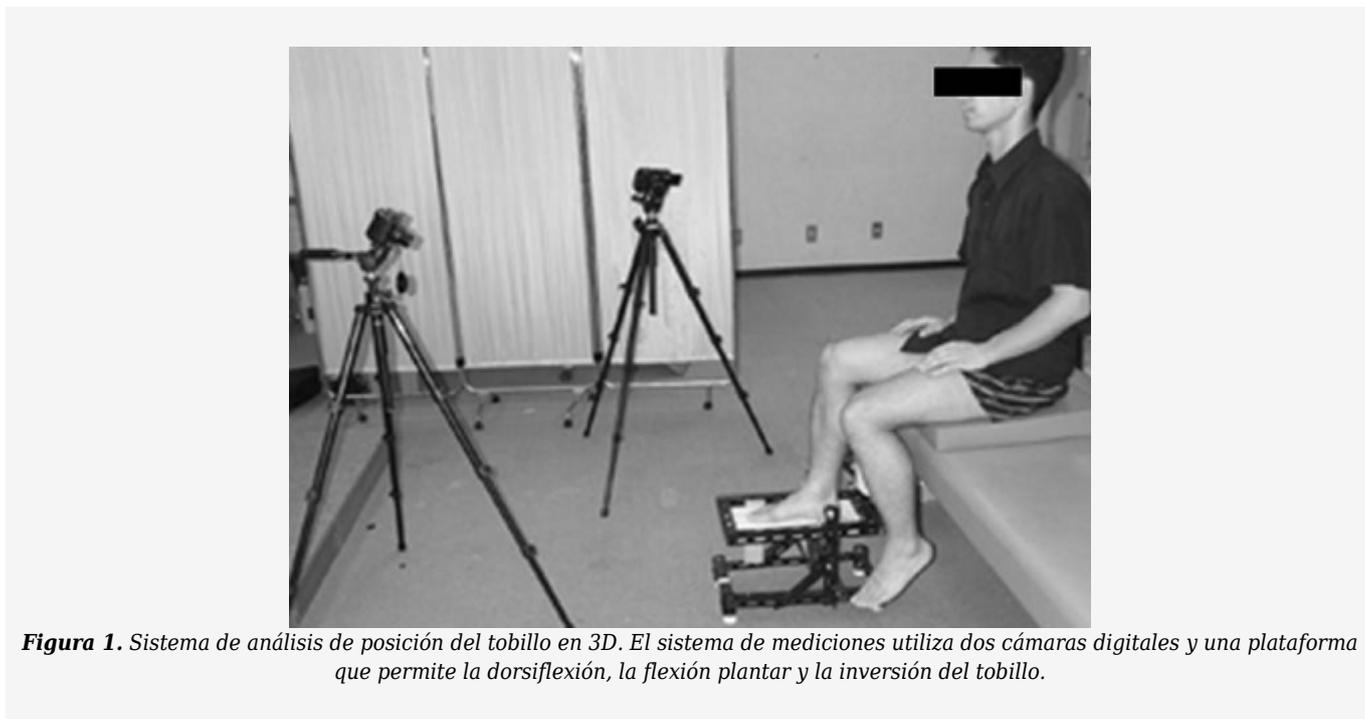
**Figura 1.** Sistema de análisis de posición del tobillo en 3D. El sistema de mediciones utiliza dos cámaras digitales y una plataforma que permite la dorsiflexión, la flexión plantar y la inversión del tobillo.
