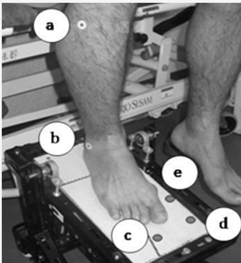
**Figura 2.** Posiciones de los indicadores del pie derecho y la plataforma. a) cabeza del peroné, (b) maléolo lateral, (c) línea media de la plataforma anterior a los dedos de los pies, (d) sobre el borde medio de la plataforma anterior a los dedos de los pies, (e) sobre el borde medio de la plataforma medial a la 1ª articulación MP.
