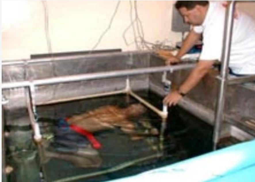
**Figura 1.** Un cliente sumergido en el agua durante la medición del peso subacuático usando un sistema con una plataforma de célula de carga.
