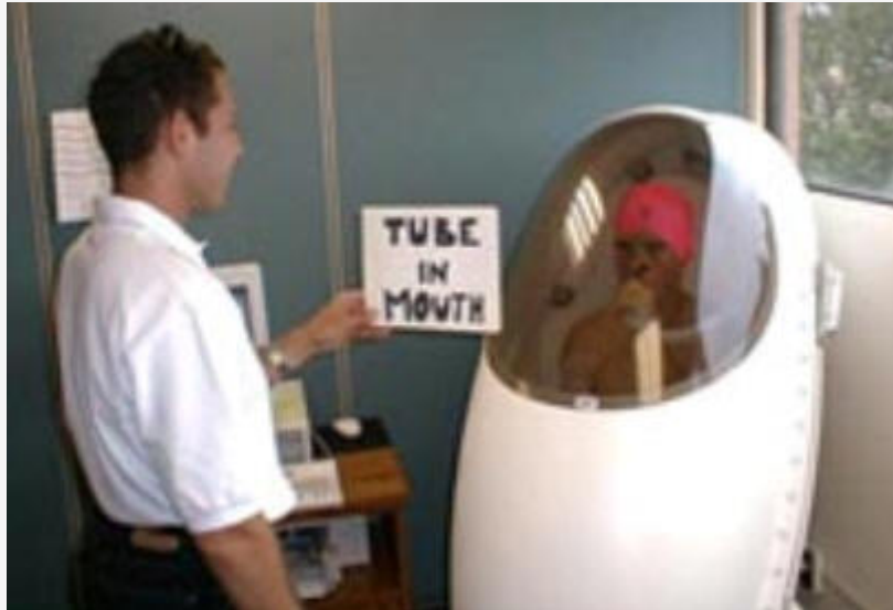
Figura 3. Un cliente en un Bod Pod™, al cual le esta siendo medida la densidad corporal por medio de la pletismografía por desplazamiento de aire.
