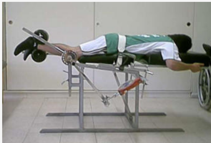
Figura 1. Evaluación del torque isométrico máximo de isquiotibiales
