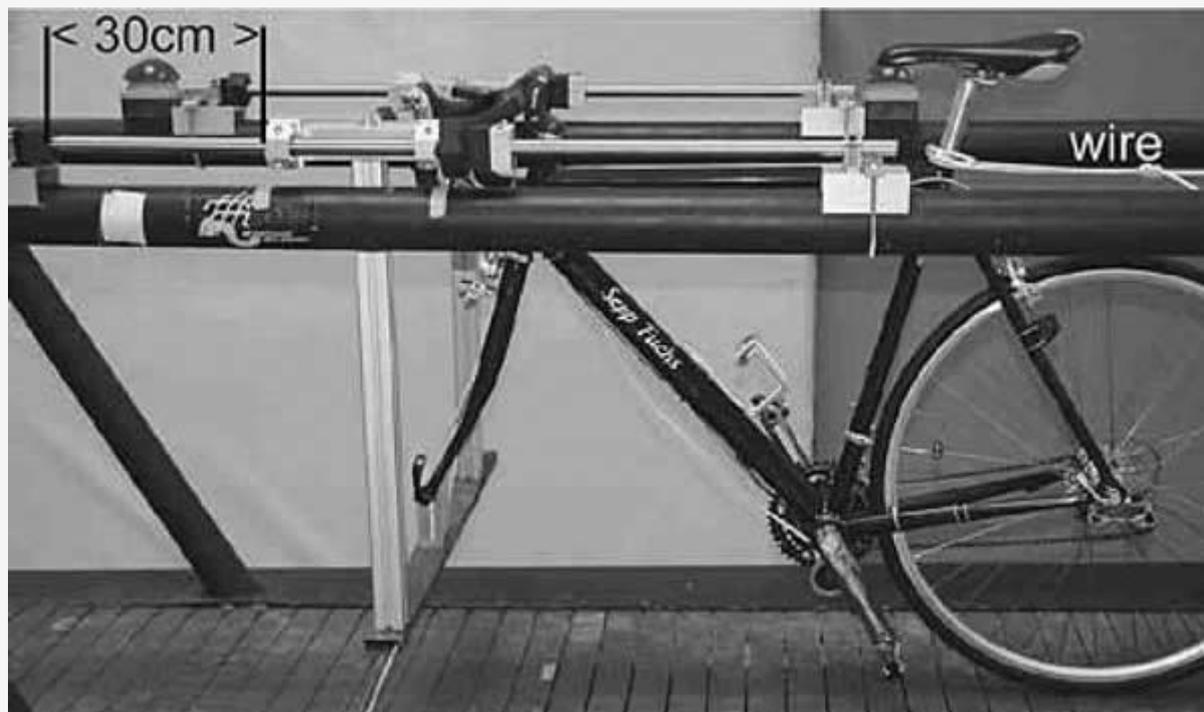
**Figura 4.** Bicicleta estándar montada en la cinta rodante. La horquilla se fijó al carro deslizante, lo que permitió el movimiento horizontal de la bicicleta en relación con el laboratorio (30 cm).
