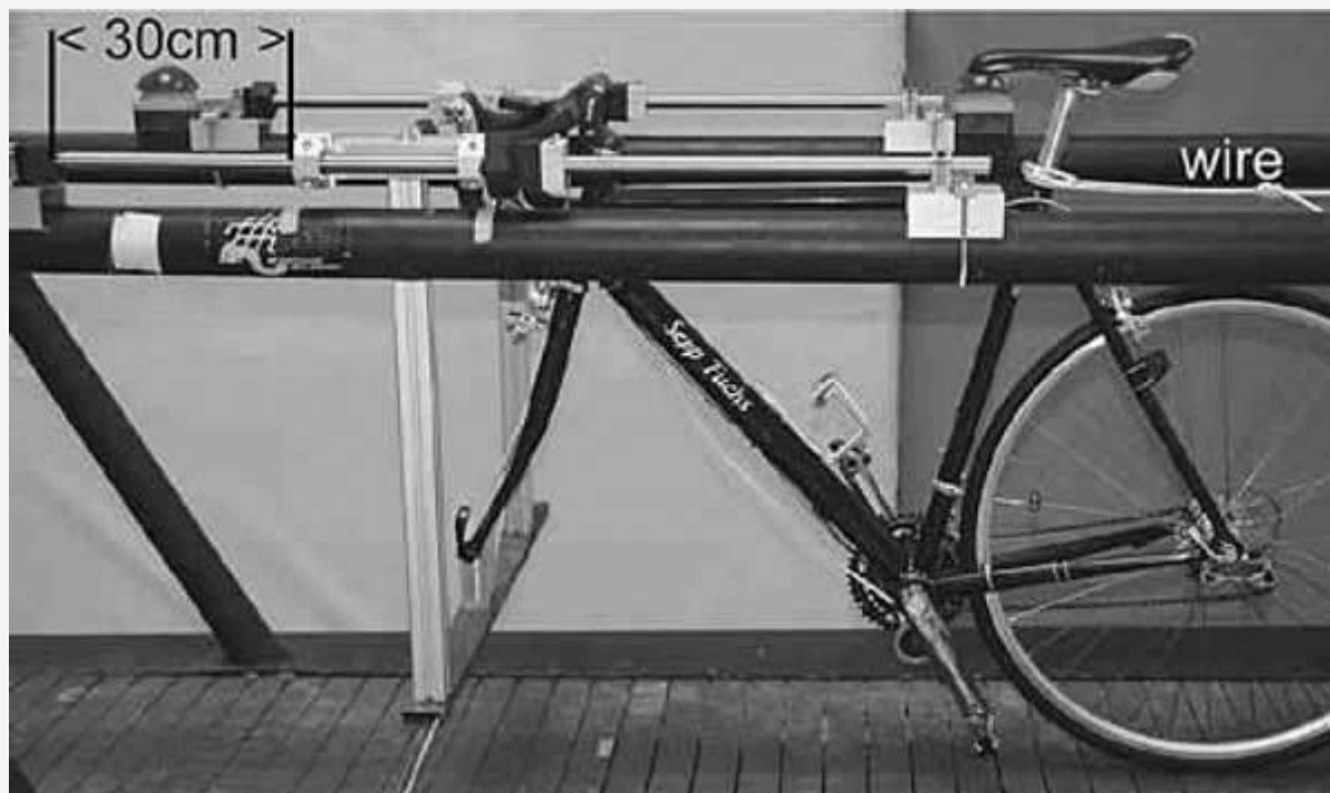
Figura 4. Bicicleta estándar montada en la cinta rodante. La horquilla se fijó al carro deslizante, lo que permitió el movimiento horizontal de la bicicleta en relación con el laboratorio (30 cm).
