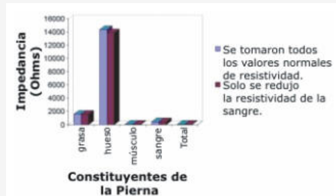
Figura 1. Impedancia eléctrica de los diferentes constituyentes de la pierna con una resistividad normal y una resistividad reducida de la sangre desde 150 a 125ohm-cm.
