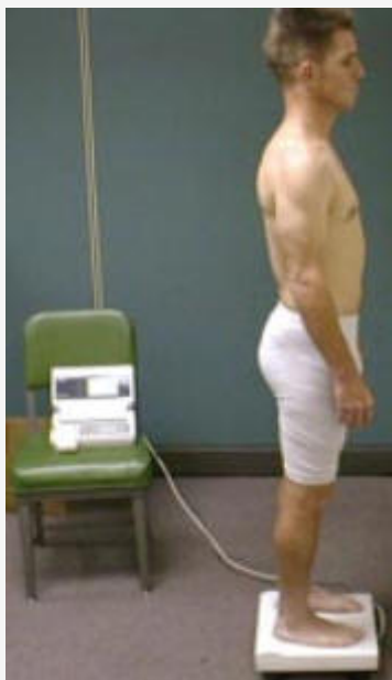
Figura 8. Un cliente siendo medido por medio de BIA usando el analizador para el tren inferior Tanita™.
