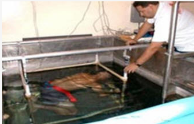
Figura 1. Un cliente sumergido en el agua durante el pesaje hidrostático usando un sistema de plataforma con celda de carga.
