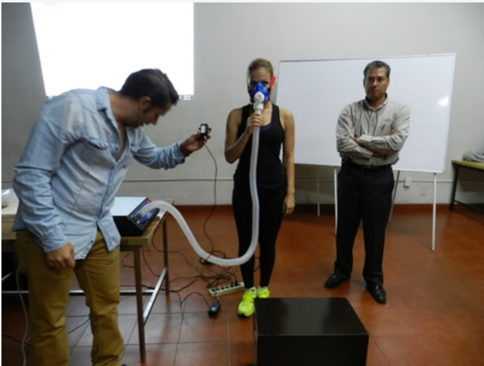
Figura 2. Colocación y calibración de calorímetro.
