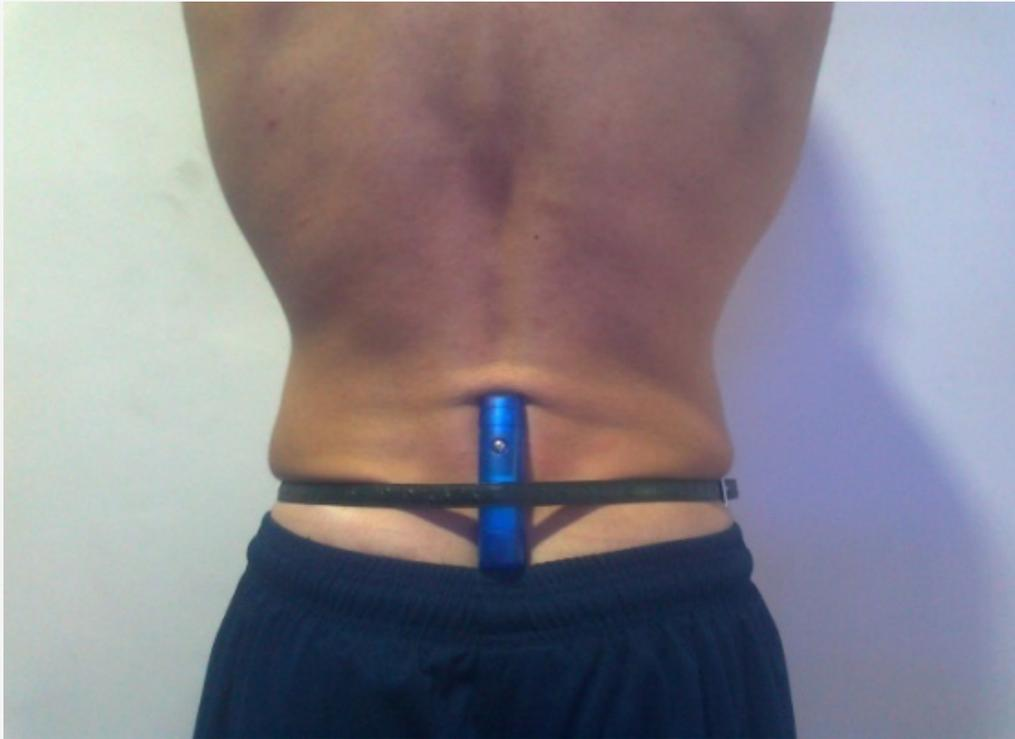
**Figura 6.** Fijación lumbar del acelerómetro.
