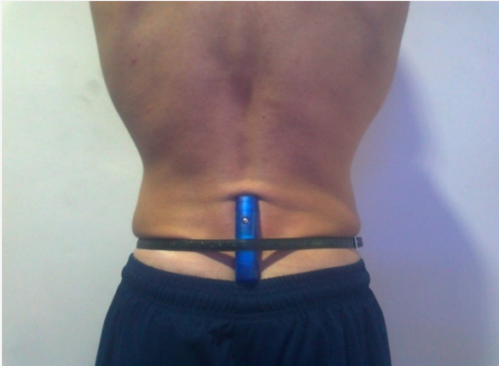
Figura 6. Fijación lumbar del acelerómetro.
