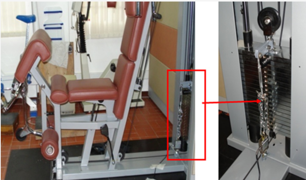
Figura 4. Adaptación de la celda de carga TESYS 400 a una maquina multi-fuerza para la evaluación de la fuerza isométrica máxima
