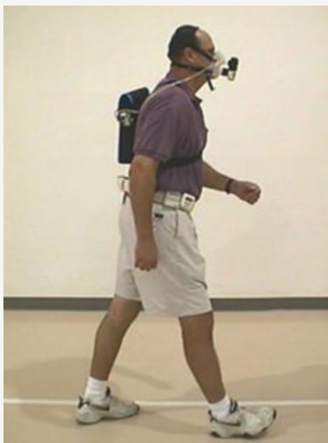
Figura 1. Fotografía de un participante realizando la prueba de caminata portando la unidad AeroSport KB1-C sujeta a la espalda y con los acelerómetros Caltrac y BioTrainer ceñidos a un cinturón alrededor de la cintura del sujeto.
