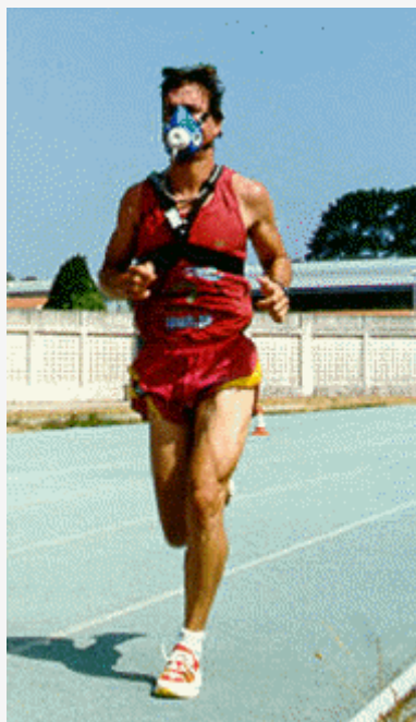
Figura 2. Atleta realizando una prueba de esfuerzo en pista empleando un sistema telemétrico para la medición del consumo de oxígeno.
