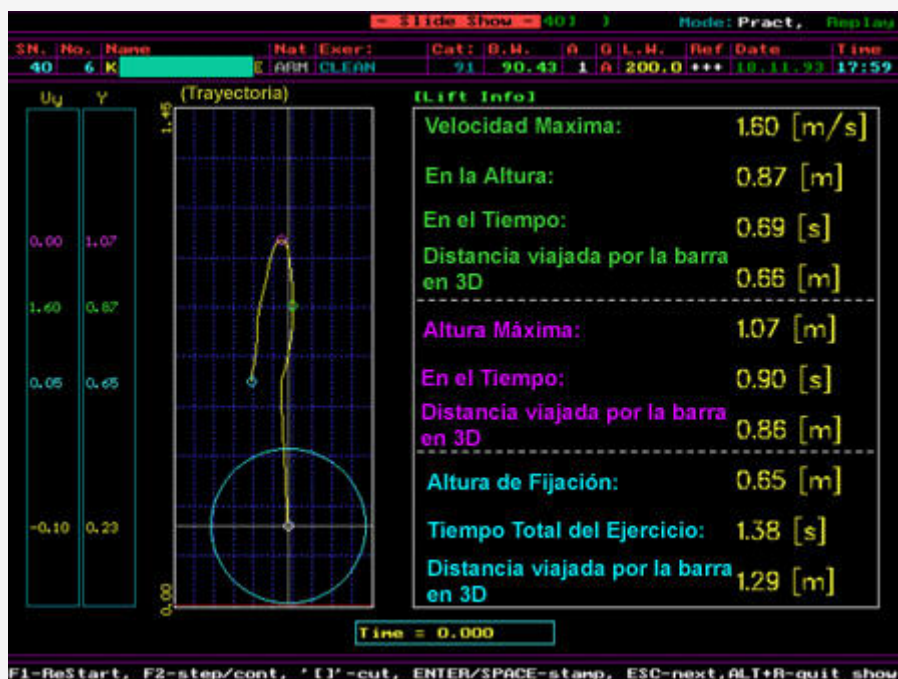
Figura 10. Trayectoria de la barra - desliz en el envión
