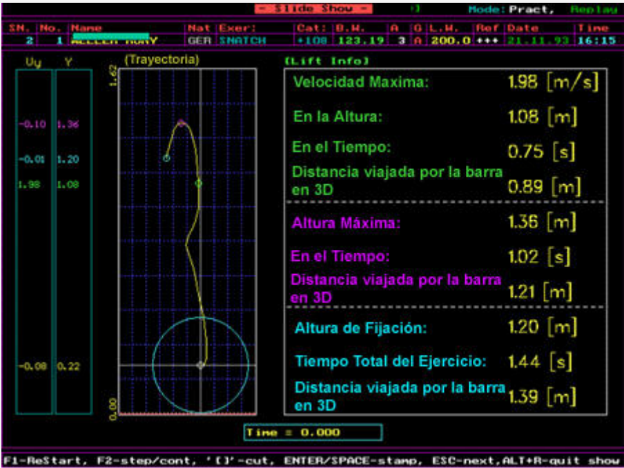
Figura 9. Trayectoria de la barra - Trazado de la trayectoria de la barra utilizando el V-scope - el levantador es observado desde la derecha.
