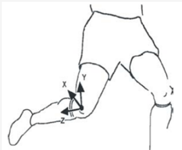
Figura 1. La ubicación del acelerómetro triaxial en la rodilla de un sujeto. Las direcciones x, y, z son laterales (de derecha a izquierda), horizontales (de atrás hacia adelante) y verticales (de arriba hacia abajo) en relación con la tibia de los sujetos.
