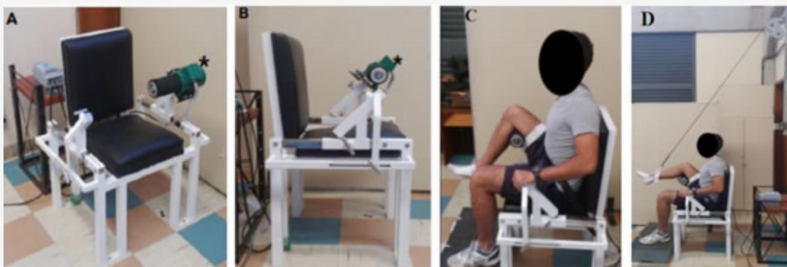
**Figura 2.** Silla Vibradora (A: Vista frontal, B: Vista lateral, \*Dispositivo Vibratorio, C: Posición del Sujeto, D: Estiramiento mediante Flexmachine).
