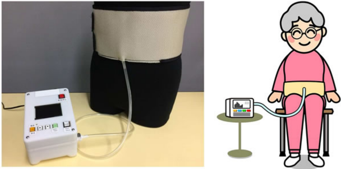
Figura 1. Dispositivo innovador de ejercicio para la musculatura abdominal. (izquierda) foto del dispositivo. (derecha) ilustración de un sujeto con el dispositivo.
