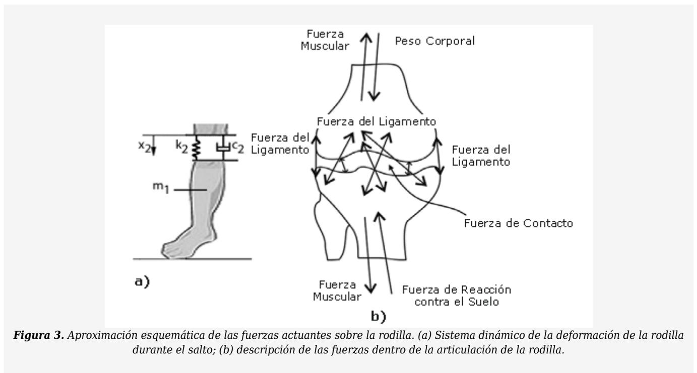
**Figura 3.** Aproximación esquemática de las fuerzas actuantes sobre la rodilla. (a) Sistema dinámico de la deformación de la rodilla durante el salto; (b) descripción de las fuerzas dentro de la articulación de la rodilla.
