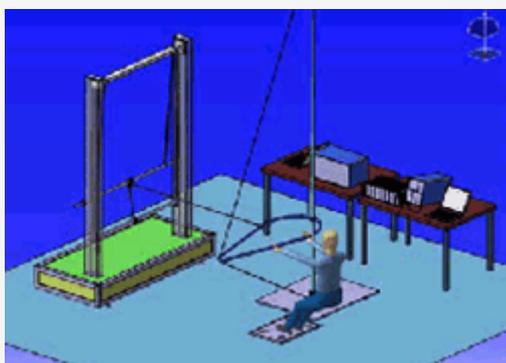
**Figura 1.** Diagrama de representación del simulador de windsurf terrestre que permite la simulación de una práctica de windsurf utilizando el software CATIA V5. El sistema estaba compuesto por varios elementos: Una barra de levantamiento de pesas electrónica que representaba la fuerza de tracción aplicada a la botavara mediante un cable de acero, el sistema de análisis electromiográfico y la base fija para el mástil.
